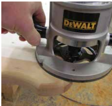
Routing the bottom edge
